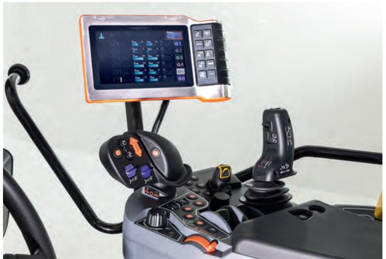
Beim Kubota M7003 können Sie optional alle Bedienelemente in die moderne Armlehne integrieren. Alle Bedienelemente, die Sie regelmäßig brauchen, haben Sie in Reichweite, ohne dafür den Arm heben zu müssen. Das bedeutet für Sie noch mehr Komfort und ein Plus an Produktivität – intuitive Bedienung inklusive.
