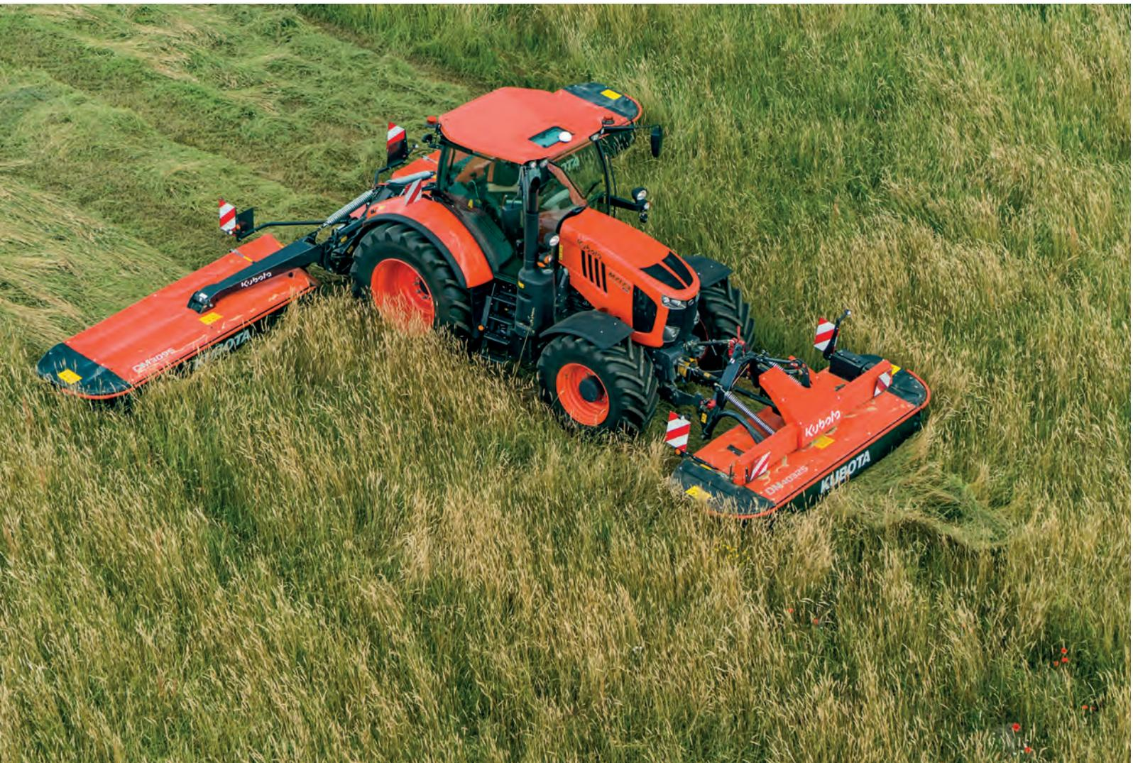
Die gewaltige Hubkapazität des M7003 von 9.400 kg ermöglicht Ihnen ein schnelles Arbeiten mit Drillkombinationen oder anderen schweren Anbaugeräten wie Pflug, Grubber & Co. Die Hubkraft von 3.900 kg des Frontkrafthebers bietet zusätzliche Hubkapazität für die einfache Bewältigung von Arbeiten, für die schwere Gerätschaften erforderlich sind. Der stabile Frontkraftheber verleiht den bereits eindrucksvollen Fähigkeiten des M7003 noch mehr Vielseitigkeit.
