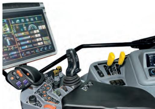
Die Premium-Modelle des M7003 bieten ein geschlossenes Load-Sensing-Hydrauliksystem mit einer variablen Durchflussmenge, versorgt von einer Axialkolben-Pumpe mit 110 l/min Förderleistung. Serie sind vier elektronisch angesteuerten Hydraulikventile. Optional sind bis zu zwei zusätzliche Ventile erhältlich. Für die Regelung hoher Durchflussmengen an Anbaugeräten ist ein Power Beyond-Anschluss verfügbar.
