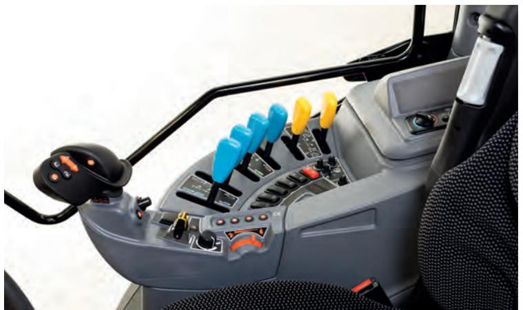
Bei allen Modellen des M7003 befinden sich einige zusätzliche Steuerungen zentral auf der rechten Seite. Der Multifunktionshebel beim Standardmodell ist in die seitliche Bedienkonsole integriert, während die höheren Modelle mit einer modernen Armlehne mit Multifunktionshebel ausgestattet sind.
