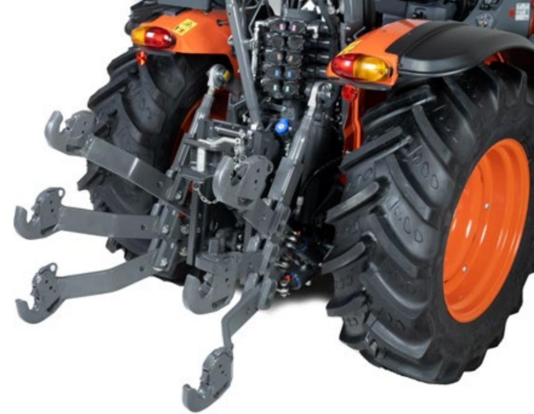
Mehr Kraft und Leistung für alle Aufgaben ist das Motto für das Hubwerk des M5002N. Dank seiner stabilen 3-Punkt-Anhängung der Kategorie II kann der Traktor mühelos schwere Geräte heben. 2.300 kg Hubkraft sprechen für sich. Sie werden diese Hubkraft schnell zu schätzen wissen.
