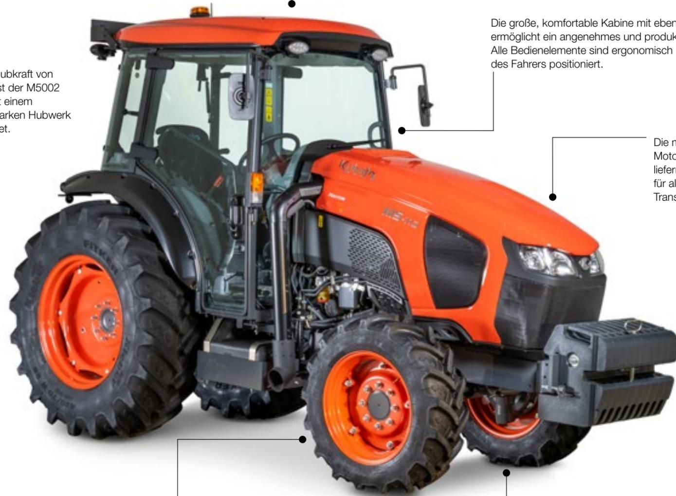
Das optionale Kabinen-Kit der Kategorie 4 schützt den Fahrer bei Pflanzenschutzanwendungen. Die Wirkstoffe der Pflanzenschutzmittel werden im Filter gebunden, während saubere Luft in die Kabine geleitet wird.
