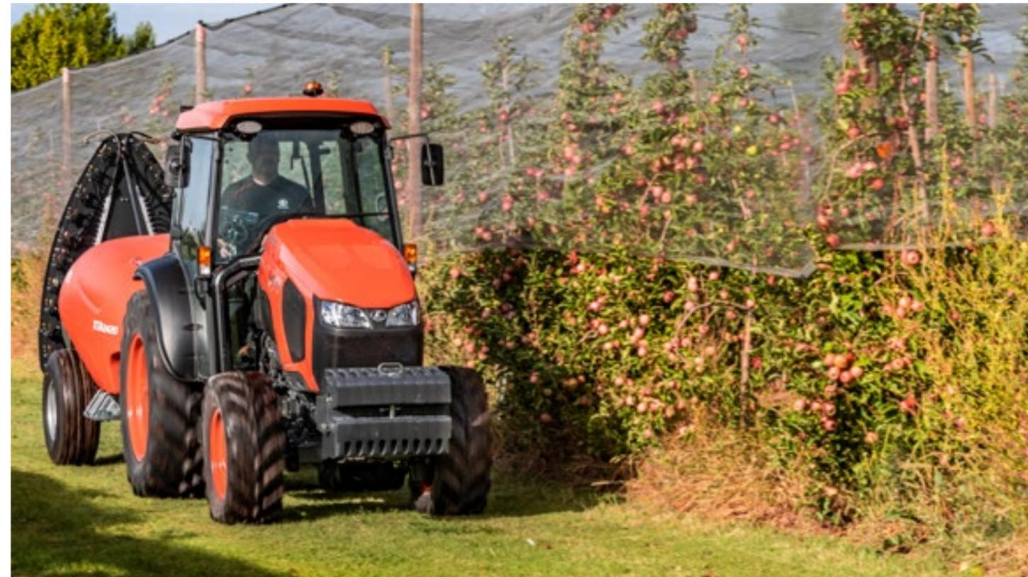
Die Kubota eigene Portalvorderachse mit doppeltem Kegelradantrieb erreicht einen Lenkwinkel von bis zu 55°. Dies verleiht dem Traktor eine extreme Wendigkeit. Dadurch ist der Traktor ideal für Arbeiten auf engstem Raum. Kubota setzt bereits seit über 30 Jahren Vorderachsen mit Kegelradantrieb ein. Aus gutem Grund, denn diese Kombination ist nicht nur für den extrem engen Wenderadius verantwortlich, sondern kommt auch ohne wartungsintensive Kreuzgelenke aus.
