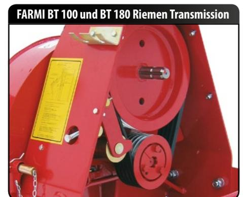
Der Riemenantrieb für die Übersetzung ins Schnelle BT100/180 verdoppelt die Drehzahl und die Hack- und Auswurfleistung. Der Kraftbedarf und damit die vom Traktor aufzubringende Leistung erhöht sich entsprechend. Als Zubehör für CH100 und CH 180/182.
