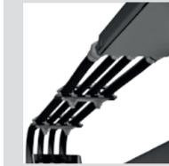
Höhere Ölfluss, und Arbeitsgeschwindigkeit für Fällköpfe mit optimaler Hydraulik (1/2" Schläuche).
