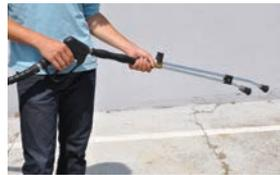
Rohr mit 2 Positionen Hoch- und Niederdruck (2 bar)
