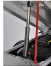
Hydraulikzylinder mit Rückschlagventil und Sicherung
