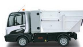
Kombinierter Müllkipper und Werkzeugkasten. Lagern von Werkzeug in einem 0,8 m<sup>3</sup> großen Kasten
