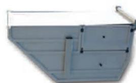
Rollabdeckung zur Vermeidung des Verlusts von Papier und Kunststoff auf der Rückfahrt zur Verwertungsstelle bei Höchstgeschwindigkeit
