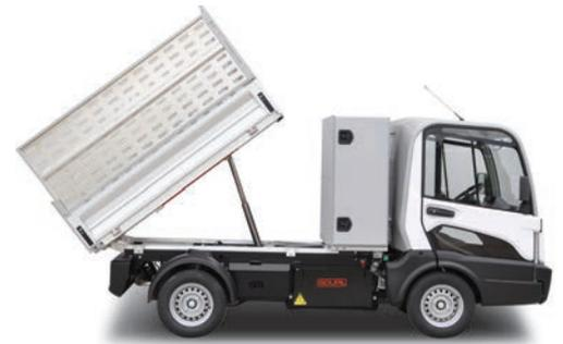
Kombinierter Kipper mit Werkzeugkasten
