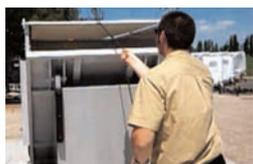
Die Abdeckung wird durch einen Federzug bewegt.
