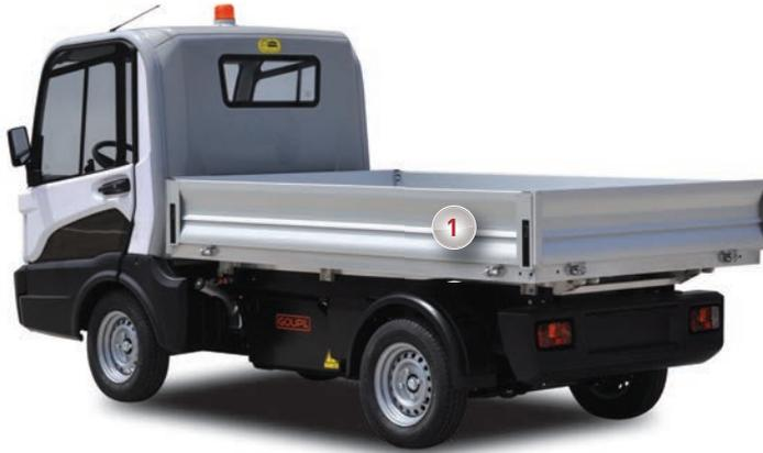
1 Seitenwände aus Aluminium
