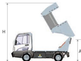
Kipphöhe 1m60 bei einem Winkel von fast 90°, um das Anhaften von Müll auf dem Sammelfahrzeug zu vermeiden
