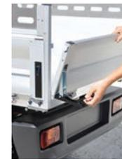
Öffnung der Seitenwände
