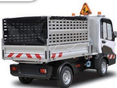
Netz mit selbstspannendem Band am Heck zur Kippentleerung der Pritsche
