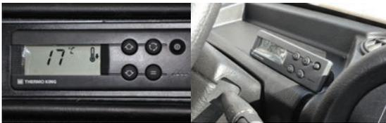
Steuerung in der Kabine mit Thermometer/digitalem LC-Thermostat
