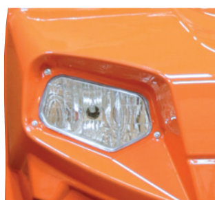
Frontscheinwerfer mit Fern- und Abblendlicht
