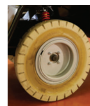
"Non-marking" schaumgefüllte Reifen
